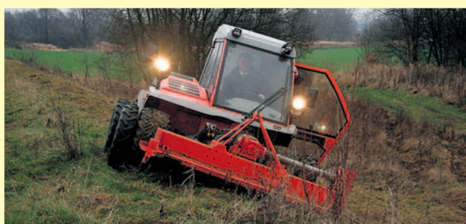
Specjalna konstrukcja i dodatkowe koła umożliwiają jazdę w najtrudniejszym, najbardziej pochylonym terenie, a osprzęt ciągnika wyłącza ludzi w ciężkiej pracy.
