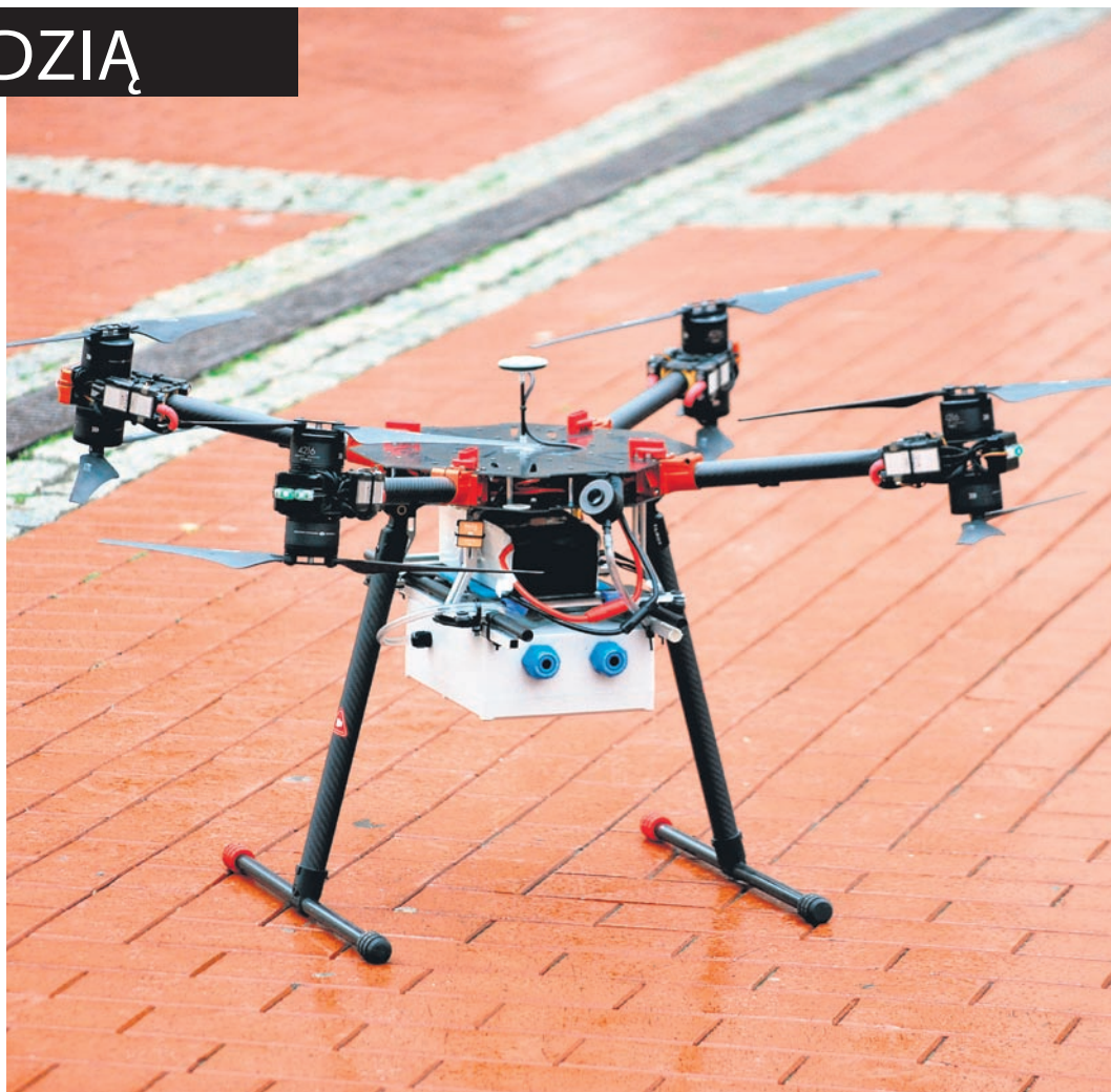
SKONSTRUOWANE W GIG-U LECIUTKIE LABORATORIUM PODPINANE JEST POD DRONA. PRZELATUJĄC NAD KOMINEM ANALIZUJE SKŁAD SPALIN I NA TEJ PODSTAWIE OKREŚLA, CO PALI SIĘ W NASZYM PIECU.
